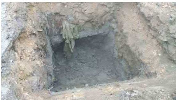
Valokuva 21. Koekuoppa VAH16. Suodatinkankaan alla havaittiin ohut turvekerros.
