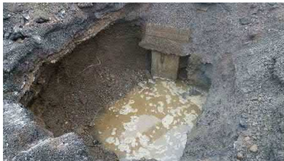
Valokuva 18. Koekuopassa VAH13 havaittiin betonirakenteita ja -laatta, jonka läpi ei päästy.
